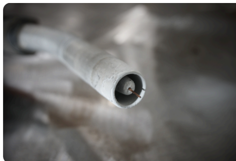
Holkki paikalleen, suihkuta suoja-spräytä ja katkaise hitsauslanka niin että se on puhdas.
